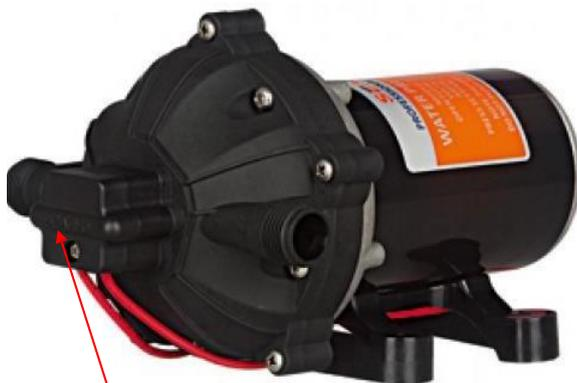
Regulierung des Abschaltedrucks – Durch Drehen dieser Schraube mit einem Inbusschlüssel kann der Abschaltedruck verändert werden.
